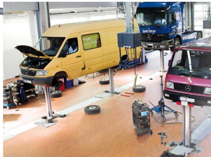
HVV pont-élévateur à 4 vérins, utilisés en 2 ponts élévateurs à 2 vérins.
